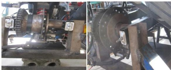
**Gambar 3.** Dinamometer
